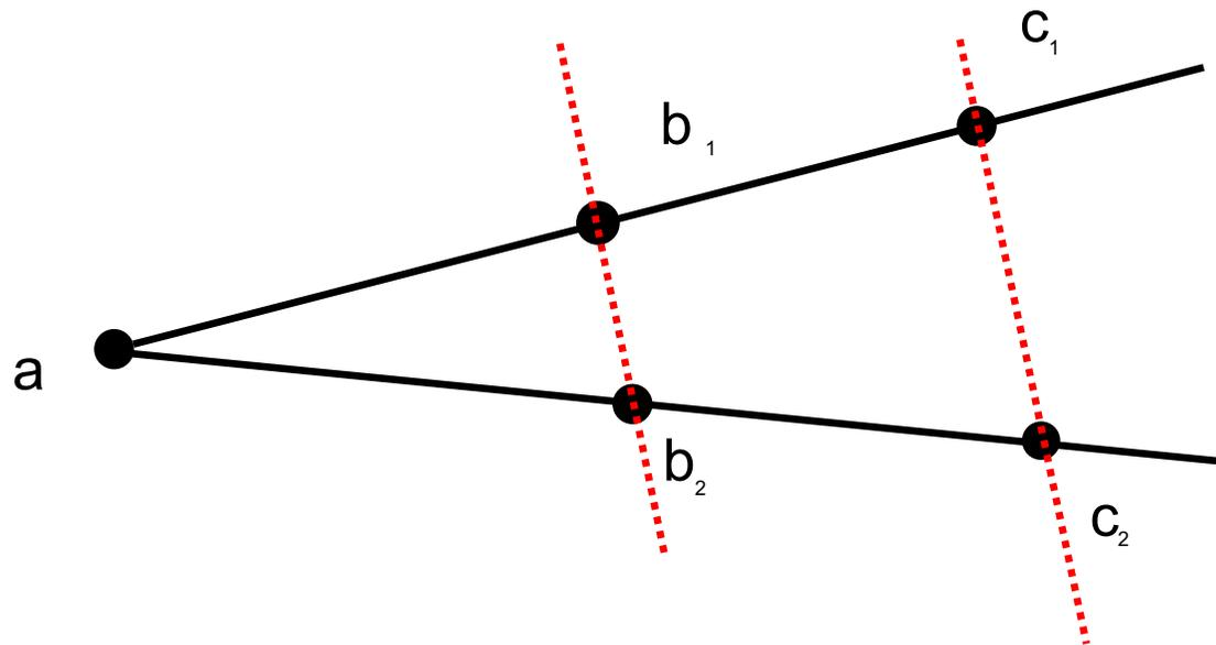
**Wiederholung.** Ist  $(a, b, c)$  ein kollineares Punktetripel und  $a \neq b$ , so heißt der durch die Gleichung  $\vec{ac} = \lambda \vec{ab}$  eindeutig bestimmte Skalar  $\lambda$  das **Teilverhältnis** des kollinearen Punktetripels  $(a, b, c)$ , bezeichnet durch  $TV(a, b, c)$ .
